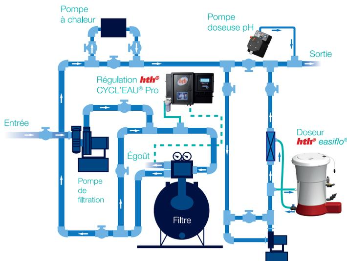
Schéma d'installation type régulation **hth® CYCL'EAU® Pro** avec doseur **hth® easiflo®**
